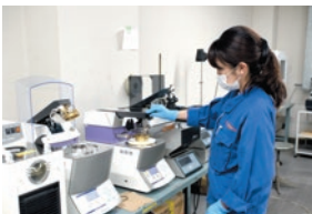
引火点試験用にサンプルをセットする様子。総面積19316kmを誇る成田工場内。
